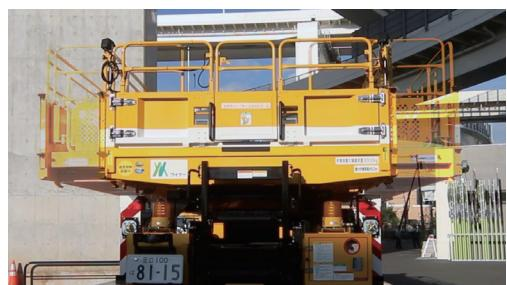
作業床は左右方向に自動拡張。大幅な作業スペースの確保が可能です。
