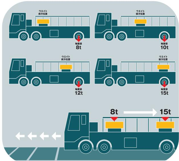
軸重試験車（軸重調整装置付試験車）は、料金所の軸重測定設備の点検に必要な、急加速・急減速に対応するエンジンパワーとブレーキ性能を兼ね備えています。また荷崩れしないウエイト構造のため、安全性を確保しながら効率的な点検が可能です。また、車両制限令を違反しない「総重量20.0t以下(19.5t)」の車両です。
